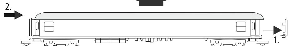
Die abgebildeten Zurüstteile sind wie grafisch dargestellt für die Selbstmontage bestimmt. Dem Produkt können zusätzliche kleine Teile beigelegt sein, die für eine andere vorbildgetreue Aufrüstung bestimmt sind und beim vorliegenden Modell keine Verwendung finden.
