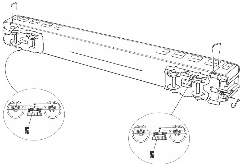
**Dachabnahme / Remove roof / Retirer le toit:**
